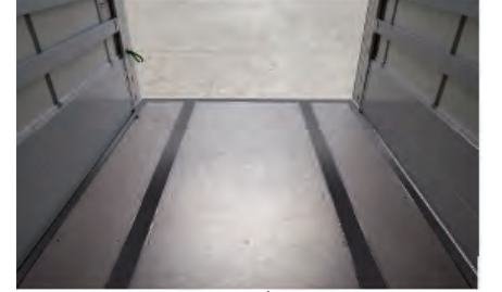
7.2 TON DAYANIMLI ŞASİYE ENTEGRE TABAN
