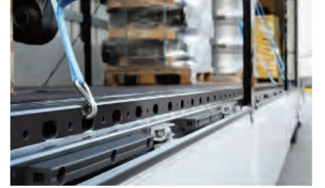
K-FIX YÜK BAĞLAMA SİSTEMİ
